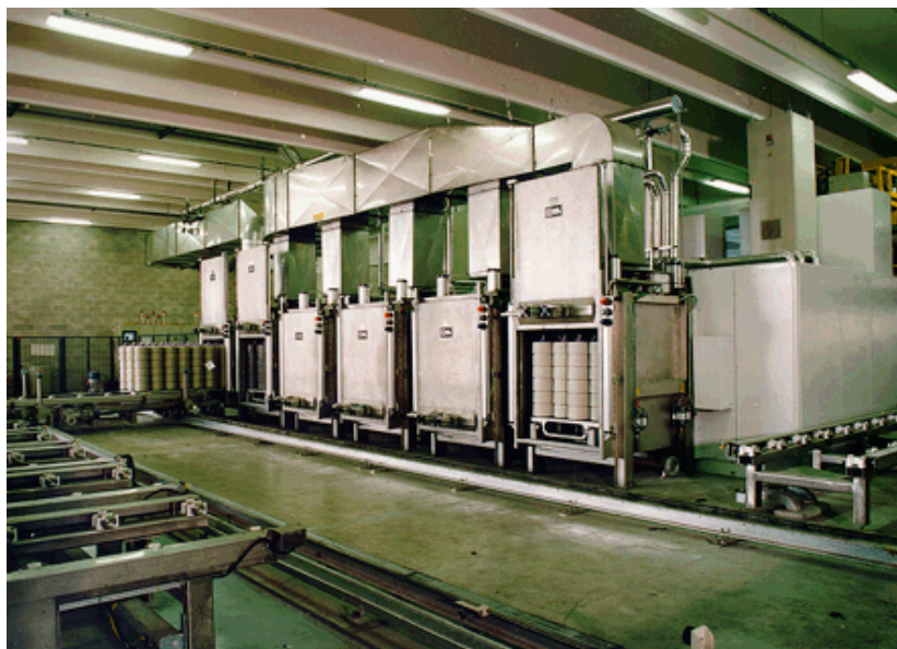
Arao 1400/3000 - asciugatoio atmosferico ad alta portata d'aria in funzionamento in impianto tintura rocche completamente robotizzato con navetta robotizzata per carico e scarico portamateriali di tintura.
